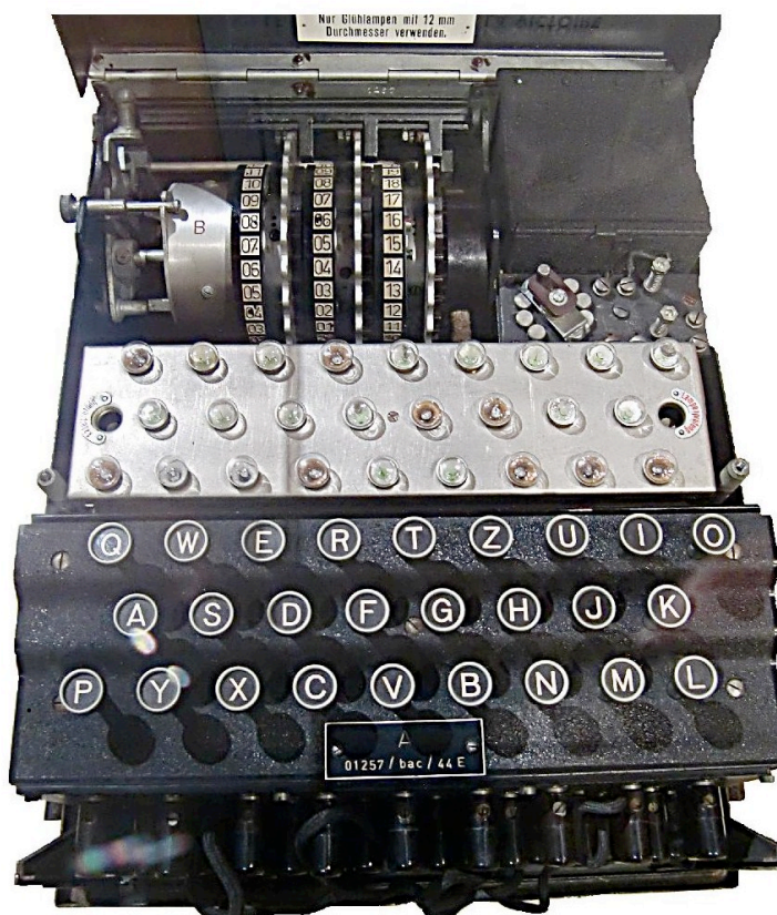
Fig. 1.11 La machine Enigma : cette vue ouverte de la machine Enigma fait apparaître les trois rotors ainsi que les lampes qui indiquent la lettre qui se substitue à celle qui est actionnée sur le clavier.
